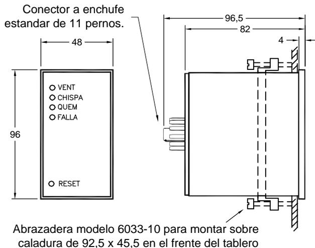
El módulo de control se colocará en el tablero eléctrico de la caldera. Se recomienda que el cableado de cargas inductivas no pase a menos de 5cm. del módulo y no forme una espira alrededor de este.
