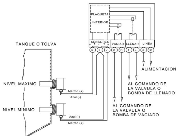
Los colores de los cables pueden cambiar según el origen del sensor.
